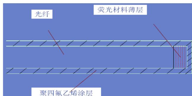
图 荧光式传感器探头结构-简单
